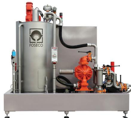
Die vollautomatische ICU von Foseco: kontrolliert die Schlichtedichte in Echtzeit und sorgt so für eine gleichmäßigere Stärke der Schlichteschicht.
